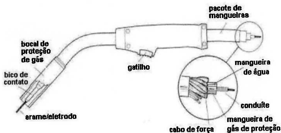
Figura 2.29 – Esquema da pistola empregada para a soldagem por arame tubular. Fonte: Bracareense [33].
