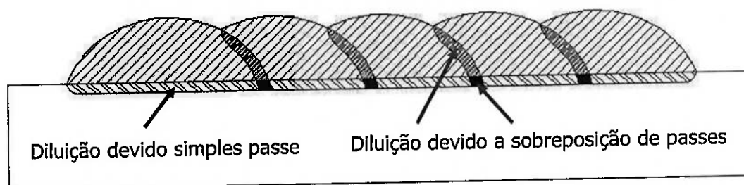
Figura 2.17c – Representação da diluição na sobreposição de passes na primeira camada.
