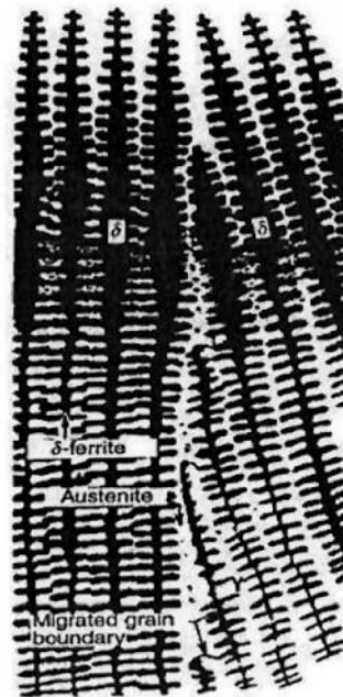
Figura 2.10 – Modo de solidificação ferrítico-austenítico. Fonte: Katayama apud Lippold [20].
